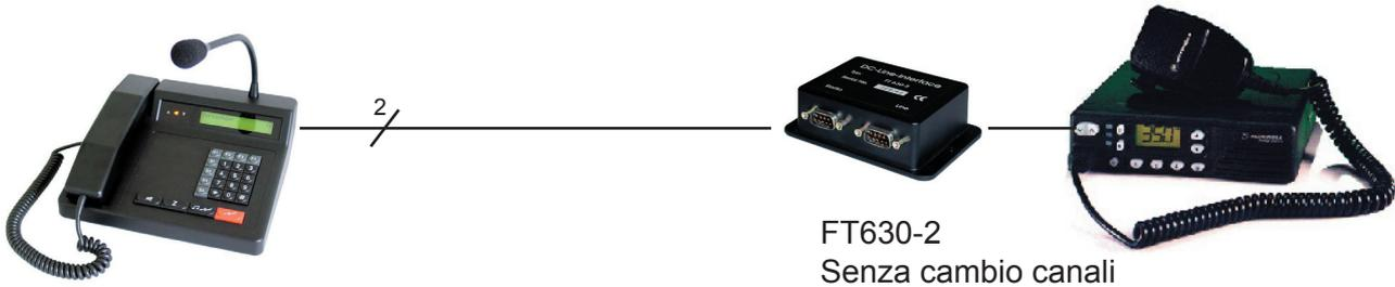
Nell'esempio seguente si attiva la funzione duplex utilizzando 4 fili e quella simplex con solamente 2 fili. In questa configurazione è possibile anche il cambio canali utilizzando una delle interfacce di linea del tipo FT634, FT634C oppure FT633AC.
